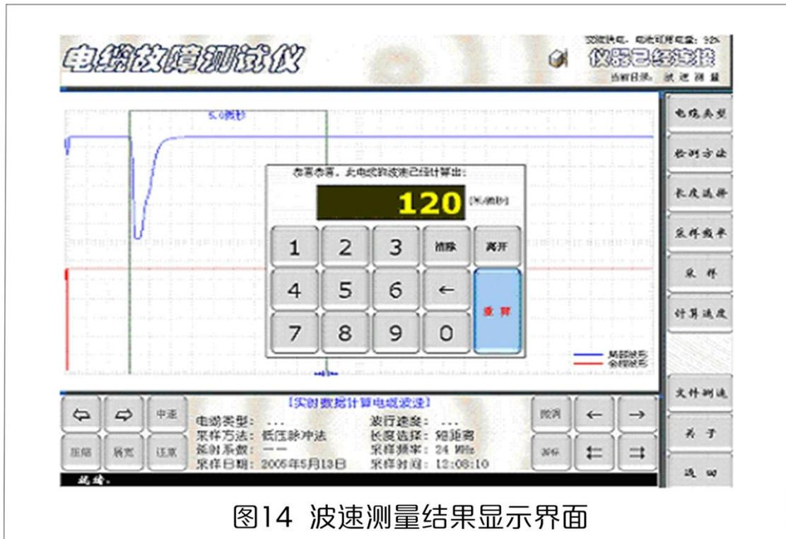
图14 波速测量结果显示界面
