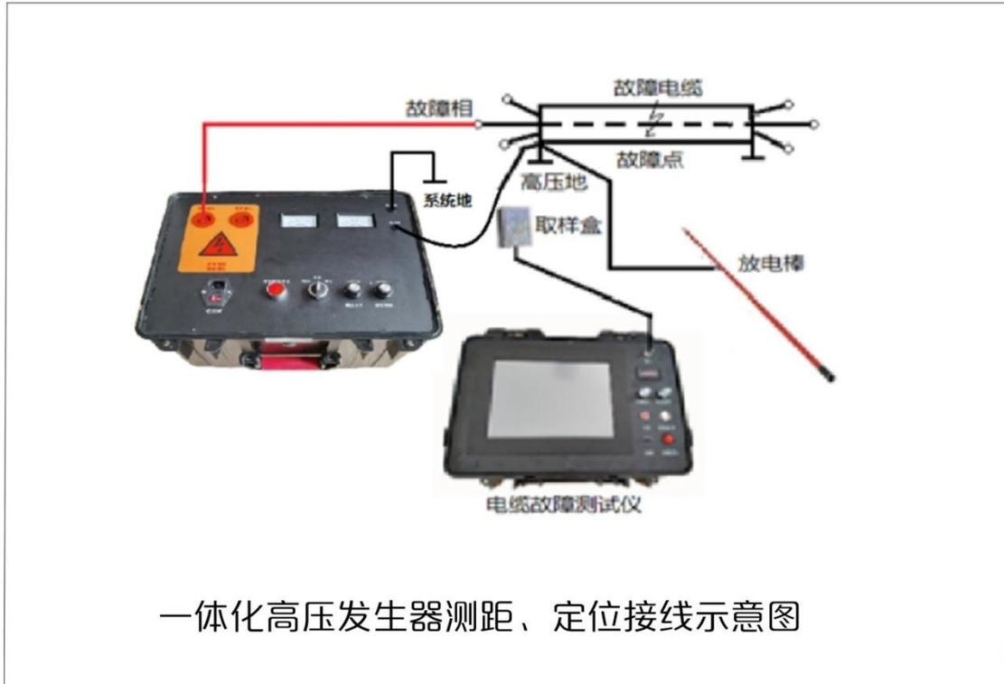
采用电流取样法,在仪器输出端接电流取样器,将电流取样器放在电缆地线与电容地线之间的附近。测试线路经检查无误即可进行高压闪络测试。只要冲击电压足够高,故障点将被电弧击穿。电流取样器将采集电缆中的反射脉冲波传送到电缆仪,并触发仪器进行数据采集,在屏幕上显示出电缆的测试波形。
