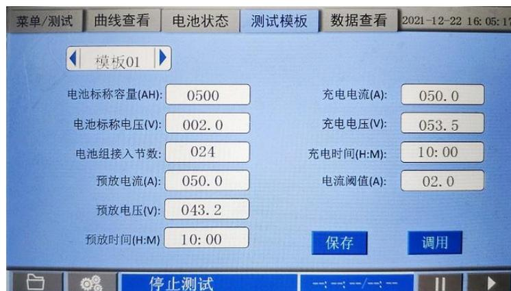
点击“测试模板”界面，进行电池参数的预设设置，最多支持预置 6 笔参数，需要测试不同容量电池组是直接调用。
