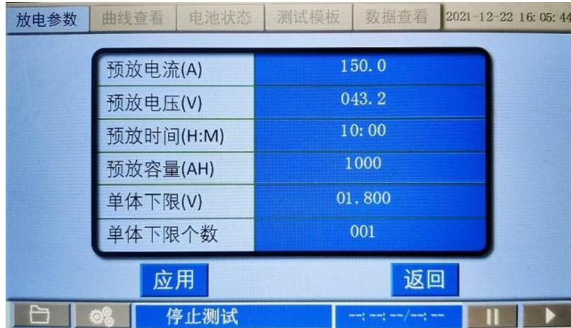
“预放电流”填入被测电池组放电电流。
