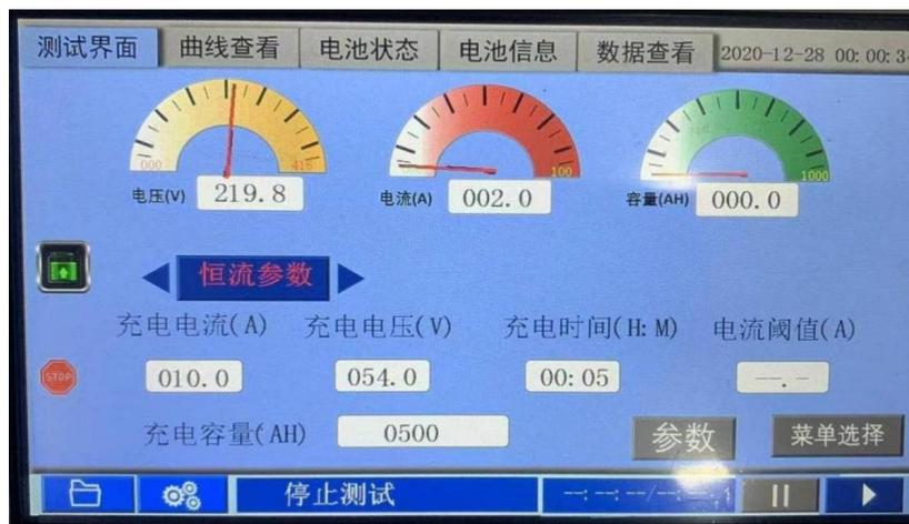
“电压”“电流”“容量”表头会实时显示电池组测试状态，范围值根据电池信息填写的参数进行跟随变化。
