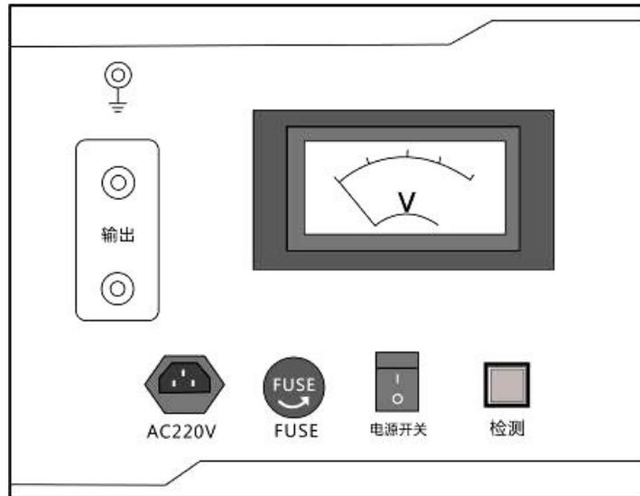
1. 将仪器输出端与避雷器计数器两端相连（连线要尽量短），红色端接上端，黑色端接地端。
