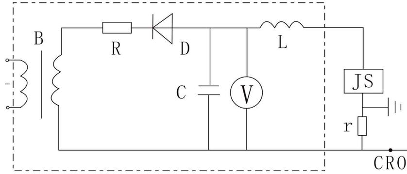
图 2 标准冲击电流检测法的原理接线
