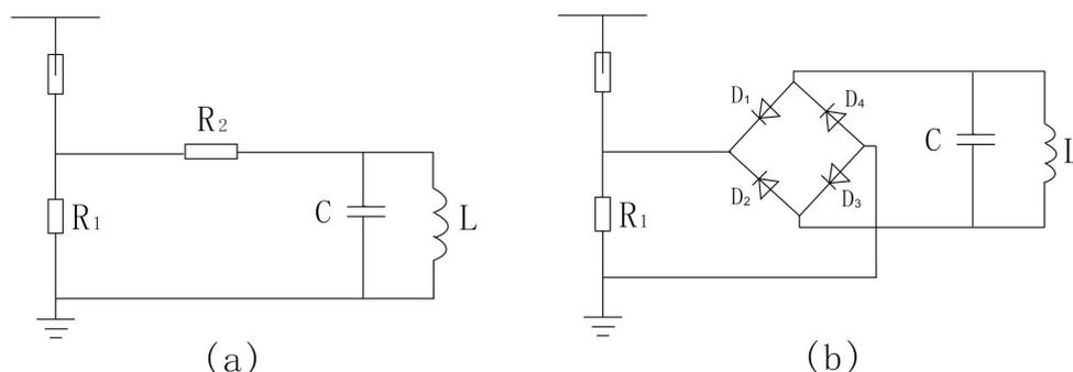
JS 型；(b) JS-8 型 R1、R2-非线性电阻； C-贮能电容器 L-计数器线圈；
