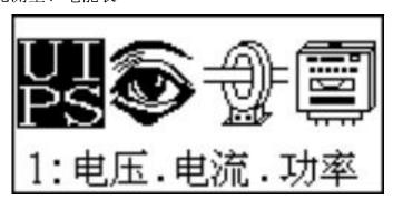
四个图标分别对应四种功能选项;最左边的图标呈反白显示,且下方有一行汉字提示信息'电压.电流.功率',这表示当前选中项为'参数测量',按左右键可切换当前的选中项(使相应图标反白显示)。如选中项为'参数测量'时按左键或选中项为'电能表'时按右键进入'菜单屏二'
