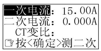
屏中一次电流呈反白显示,表明正在测量一次电流,同时提示行指出下一步要进行的操作'测二次电流',待显示电流稳定后按〈确定〉键保存所测的一次电流并进入下一步操作,如下图:
