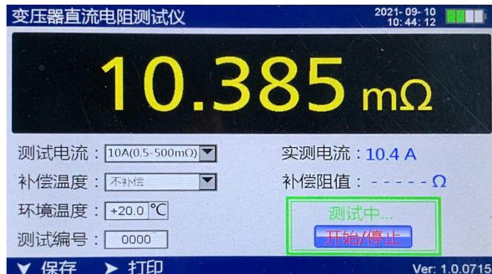
测试完毕后，按“停止”键，仪器电源断开，液晶恢复初始状态，重新接线进行下次测量，或关断电源后拆下测试线与电源线结束测量。
