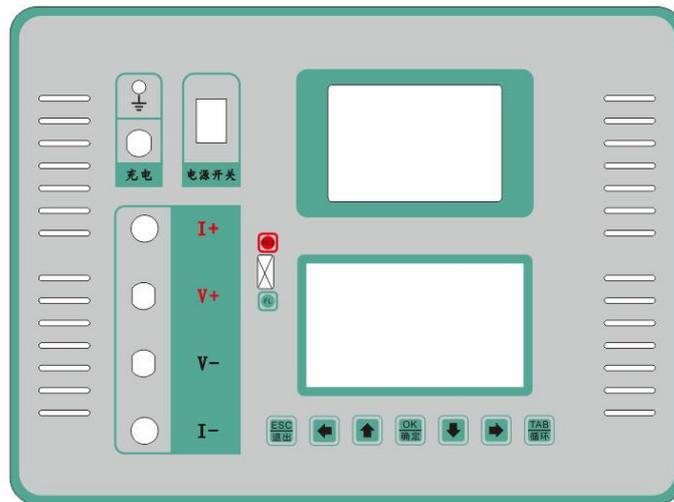
电源开关：仪器工作电源，内置可充电锂电池。
