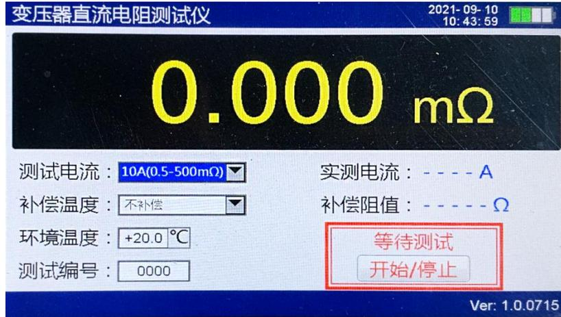
**电流选择：**按【TAB】键将光标选择在电流选项上面，可以通过【上箭头】按键、【下箭头】按键选择测试电流，选定测试电流后，按【TAB】键可光标移动到【开始/停止】按键再按【OK】按键开始测试，测试中按【OK】按键停止测试。
