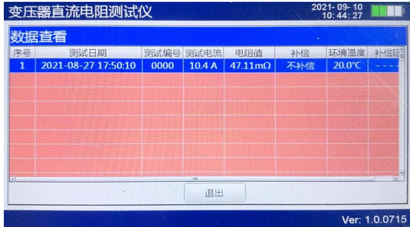
本仪器最多保存 99 组数据，超过 99 组数据自动覆盖以前的数据。在查看界面可以通过【上箭头】按键、【下箭头】按键查看数据，也可以按【OK】键调出打印和删除数据对话框进行相应数据操作，按【退出】键返回到测试界面。
